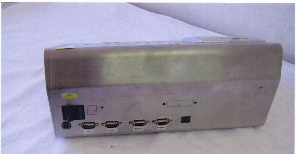
Elektroničko upravljačko pokazni uređaj diSKALA P/S zaštićuje se postavljanjem zaštitnog žiga u obliku naljepnice preko vijka koji drži poklopac kućišta.
